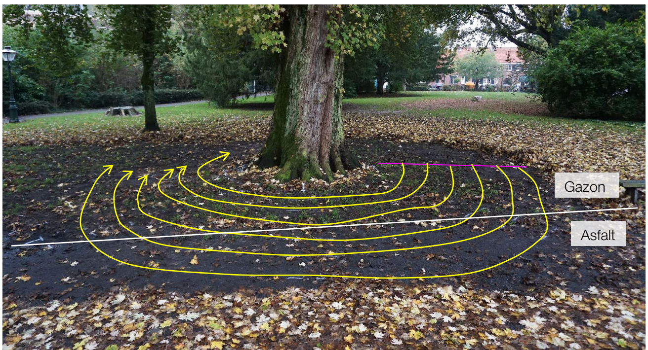
Foto 2: Principe van het cirkelvormig scanpatroon bij boomnummer 8 waarbij cirkels doorlopen tot de paarse lijn.
